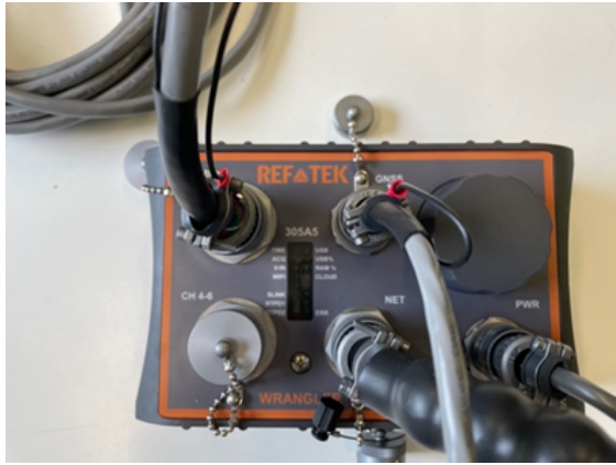
Σχ. 1 Ο ψηφιοποιητής, το σεισμόμετρο και το GPS τα οποία εγκαταστάθηκαν στην Εξωγή της Ιθάκης.
